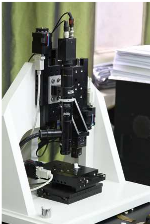
Сканирующий зондовый микроскоп «НаноСкан». Позволяет изучать морфологию и измерять физико-механические свойства поверхности на уровне наноструктур (10 нм)
