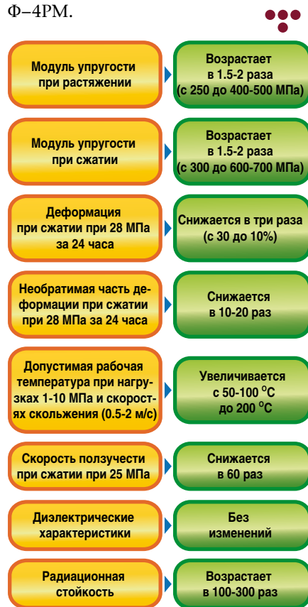
Рис. 4. Сравнительные характеристики исходного и радиационномодифицированного фторопласта Ф-4РМ.
