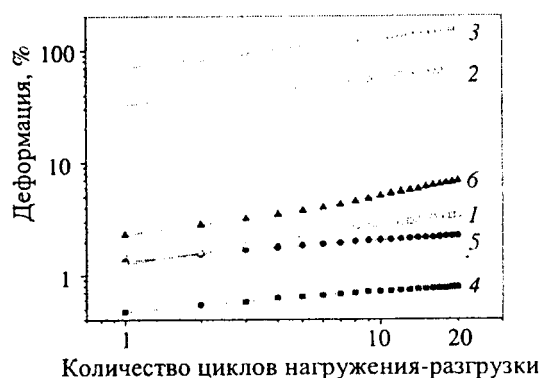
Рис. 4. Зависимость деформации исходной (кривые 1—3) и модифицированной (кривые 4—6) пластин политетрафторэтилена (толщина 3 мм) от количества циклов нагружения-разгрузки (в логарифмических координатах).
