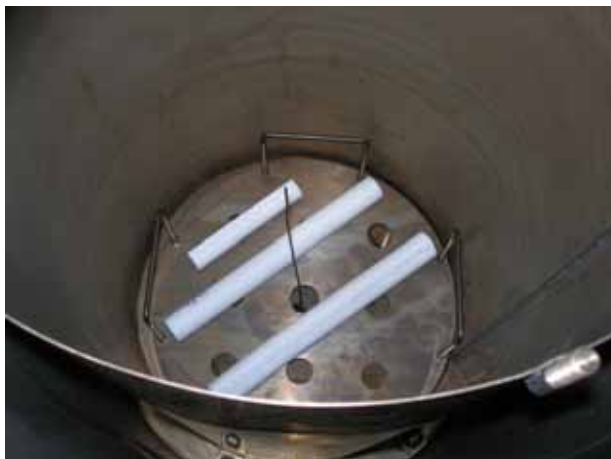
5 Заготовки ПТФЭ в опытной установке перед закалкой
